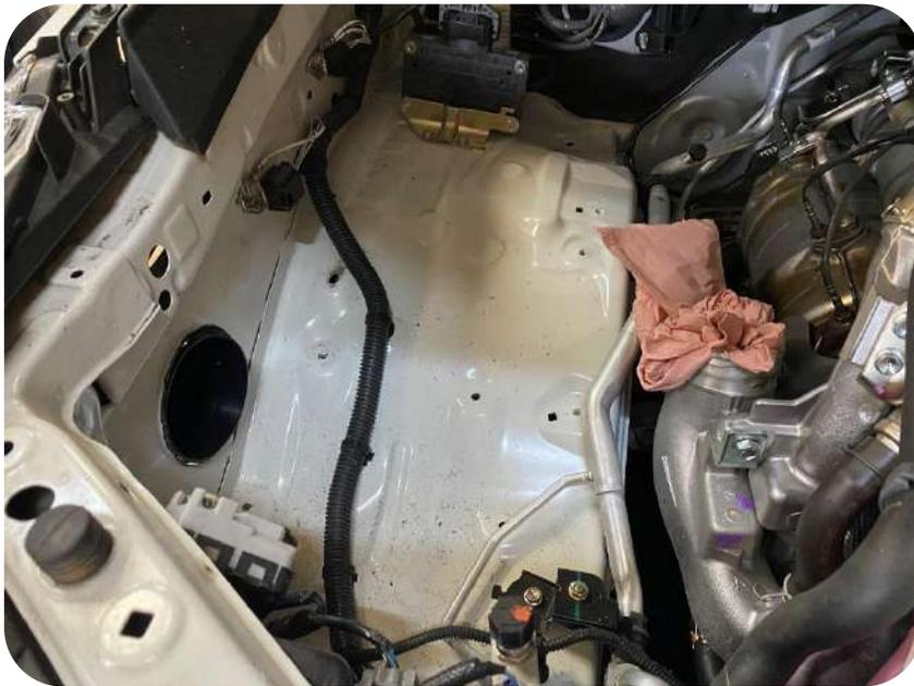
*Remplacer le raccord d'origine de la boîte à air par la durite fourni
