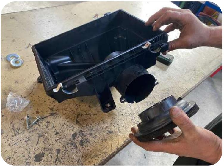
*Pour une étanchéité optimale vous pouvez colmater le trou d'évacuation d'eau de la boîte à air*
