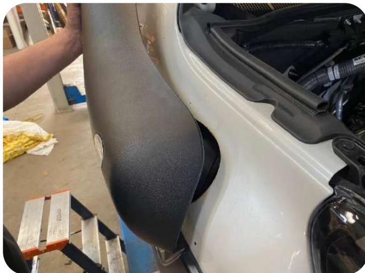
*Pour accéder à l'intérieur de l'aile, il est nécessaire de démonter le passage de roue*
